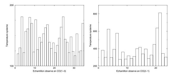
FIG. 2.5: Température système à 2.6mm (à gauche) et à 1.3mm (à droite) pour l'ensemble des sources observées avec le télescope de 30m de l'IRAM.
