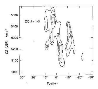
**Fig. 5.2:** Diagramme Positions-Vitesses de l'émission du CO dans NGC 1275 selon un angle (PA=110°) centré sur l'AGN (Inoue et al., 1996a).
