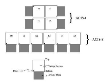
Fig. 4.3: Plan focal du spectro-imageur ACIS, d'après de CXC.
