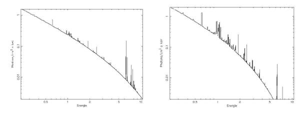
**Fig. 4.5:** Modèle de type mekal, pour deux températures du gaz. A gauche, T=6keV, à droite T=2keV. Les autres paramètres sont identiques, la métallicité est fixée à 0.3  $Z_{\odot}$ .
