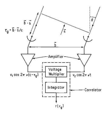
Fig. 5.4: Schéma de principe d'un interféromètre radio à deux antennes (Thompson, 1986)
