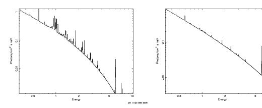
FIG. 1.6: Spectres modélisés : émission continue du plasma chaud et diffus (bremsstrahlung) + raies d'émission de plusieurs éléments, principalement le Fe. Flux de photons par keV normalisé en fonction de l'énergie (à gauche T=2keV et à droite T=10keV)
