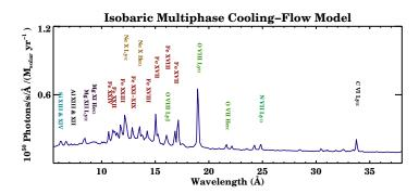
Fig. 1.9: Spectre prédit par un modèle de gaz multiphasé et isobare (cf description plus haut) d'une température maximum de 6 keV et avec une métallicité  $1/3~\rm Z_{\odot}$ , d'après Peterson et al. (2003). On peut remarquer ici l'importance des raies Fe L ainsi que les raies OVIII.
