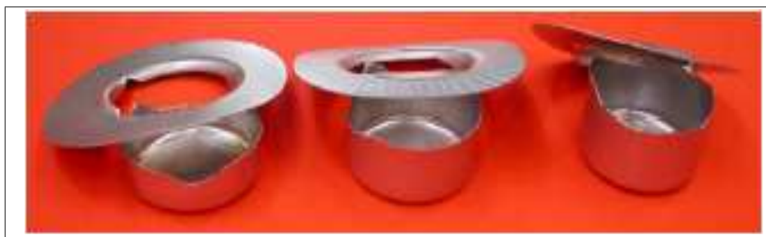
FIG. 1.9 – Défauts structuraux d'emboutissage : rupture [Lih04].
