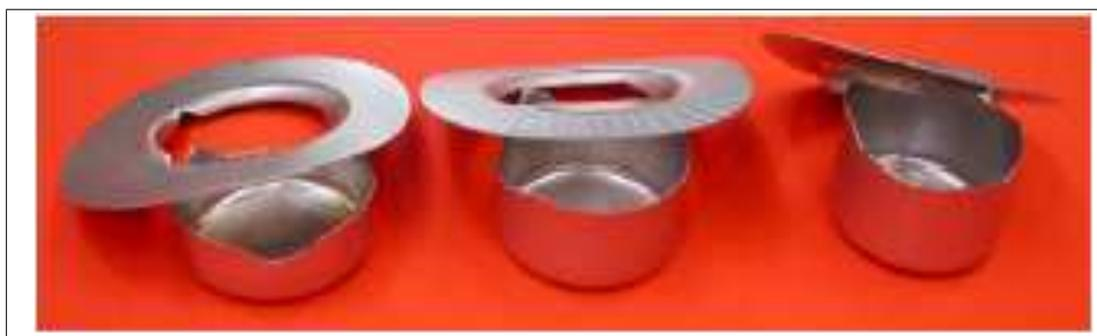
FIG. 1.9 – Défauts structuraux d'emboutissage : rupture [Lih04].
