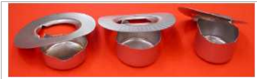
FIG. 1.9 – Défauts structuraux d'emboutissage : rupture [Lih04].
