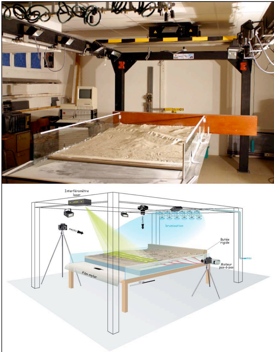
Fig.III. 30 : Dispositif expérimental. A) Photographie de la salle d'expérimentation et B) Schéma explicatif. Le dispositif est composé i) d'une table de déformation ; ii) d'un système de brumisation et iii) un banc de mesure optique. La table de déformation est composée d'un film basal qui passe sous le modèle et sous une butée rigide et qui vient s'enrouler autour d'un axe motorisé. L'enroulement du film amène le matériau contre la butée où il se déforme et génère un prisme d'accrétion. Le matériau est composé d'un mélange visco-plastique dans les parties profondes et d'un mélange granulaire en surface (voir détails dans le chapitre suivant sur les matériaux). Le système de brumisation est composé de 12 buses disposées en série au-dessus de la butée fixe. Elles sont alimentées par une pression de 4 bars. Le système d'acquisition est composé d'une série d'appareils photographiques disposés tout autour de la table de déformation et d'un interféromètre laser. Les appareils photographiques fournissent les données morphologiques, cinématiques (champ de déplacement par corrélation d'images) et topographiques. (Remarque : Sur la photographie, la table a été retournée à 180° par rapport au portique pour les besoins de la prise de vue)
