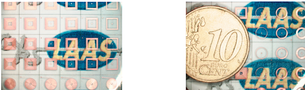
a) b) Figure 3.47. Vue générale d'inductances réalisées sur Pyrex® a) Inductances orthogonales, b) Inductances circulaires
