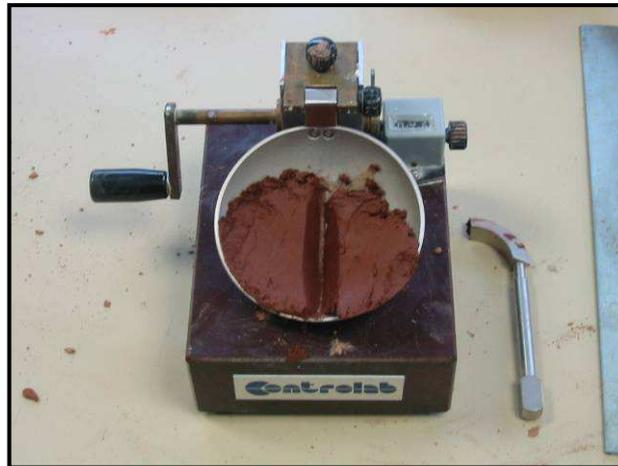
**Figure 12 :** Appareil de Casagrande pour la détermination de la limite de liquidité
