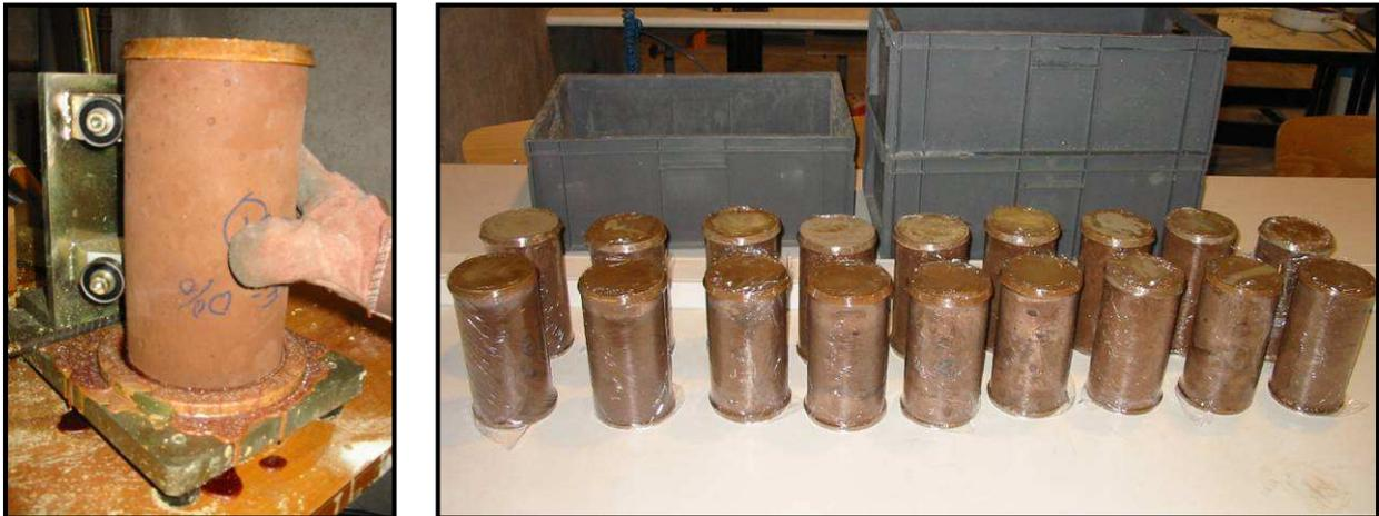
**Figure 7 :** Soufrage des éprouvettes avant l'essai de compression
