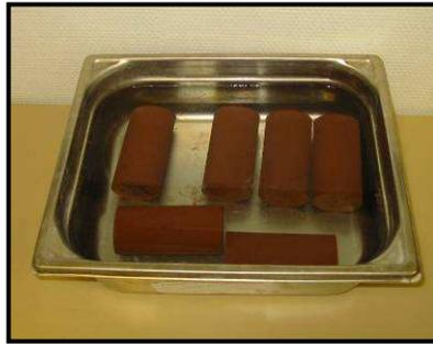
**Figure 18 :** Immersion des éprouvettes destinées à la détermination de  $R_{ci}$
