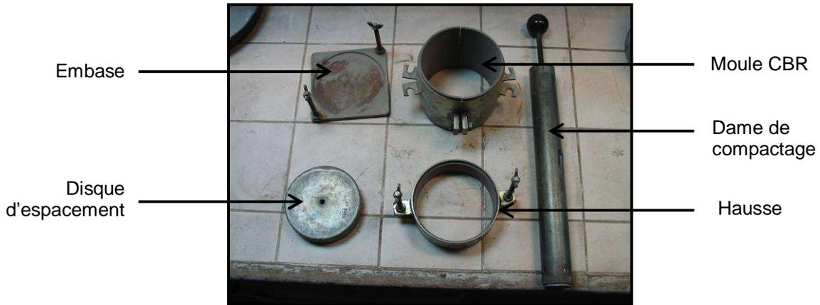
**Figure 15 :** Matériel de l'essai Proctor Normal
