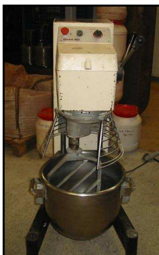
**Figure A2-1 :** Malaxeur utilisé pour la préparation des mélanges
