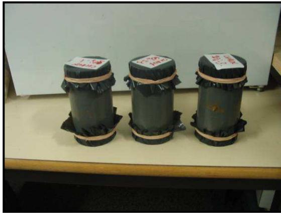
**Figure A2-9** : Conservation des éprouvettes dans les étuis en PVC
