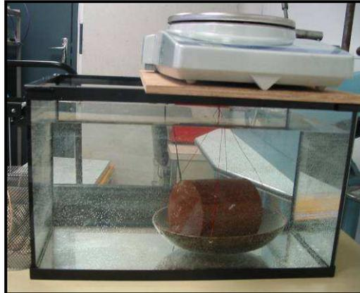
**Figure 9 :** Pesée hydrostatique d'une éprouvette 10 x 10
