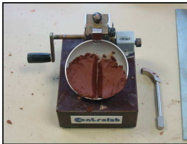
Figure 12 : Appareil de Casagrande pour la détermination de la limite de liquidité
