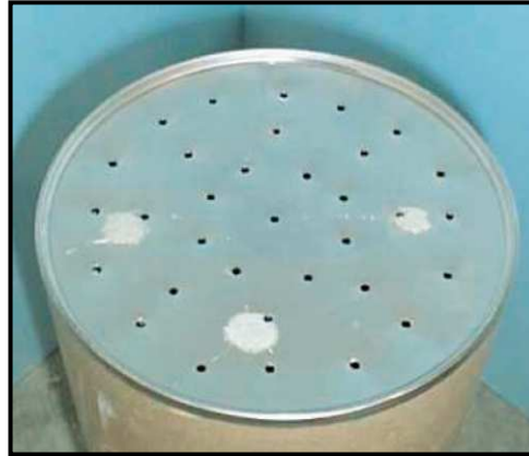
Figure 5 : Fond d'un moule percé (simulation du cas essorable)
