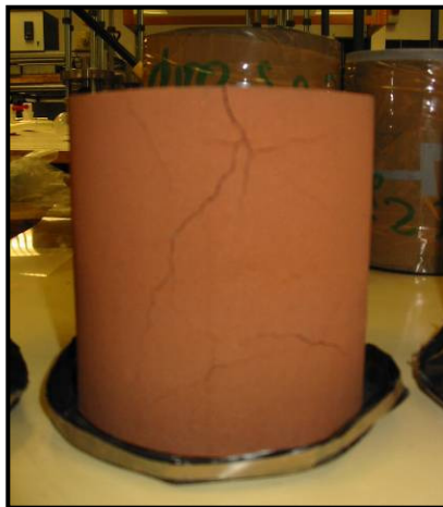
Figure 12 : Fissures sur les éprouvettes traitées au Roc Sol
