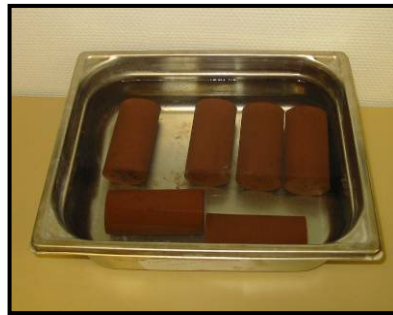
Figure 18 : Immersion des éprouvettes destinées à la détermination de R_{ci}
