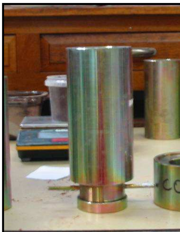
Figure A2-6 : Disposition du moule lors du remplissage avec les demi-coquilles d'espacement
