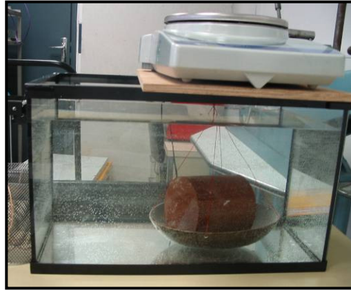
Figure 9 : Pesée hydrostatique d'une éprouvette 10 x 10
