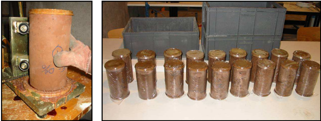
Figure 7 : Soufrage des éprouvettes avant l'essai de compression
