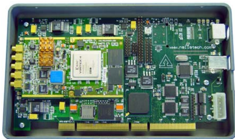
FIG. 2.10 – Kit de développement XtremeDSP pour Virtex-4.
