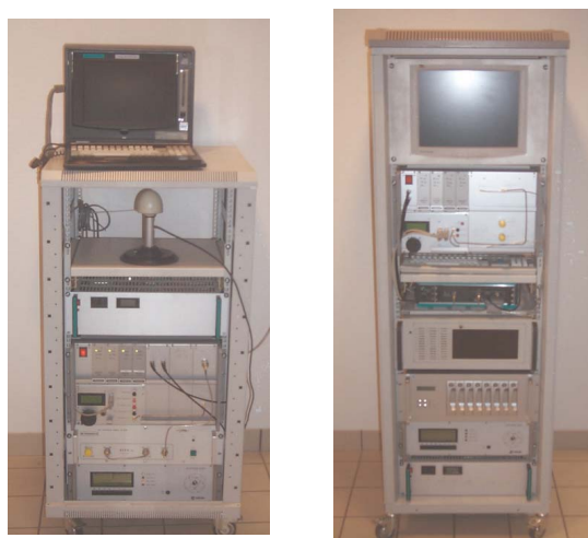
FIG. 2.4 – Emetteur et récepteur du sondeur temporel réalisé à l'IETR.
