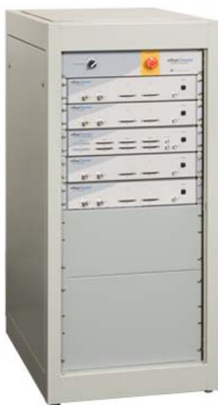
FIG. 1.16 – Simulateur matériel TrueChannel de LitePoint dans sa configuration 4 \times 4 .
