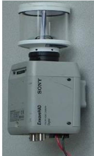
FIG. 1.6 – Exemple de capteur catadioptrique
