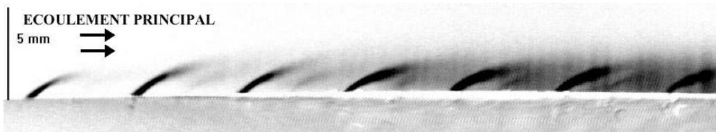
FIG. 2.4 - *Image d'un film de refroidissement. Visualisation par fumée issue de la thèse de [Rouvreau \(2001\)](#).*
