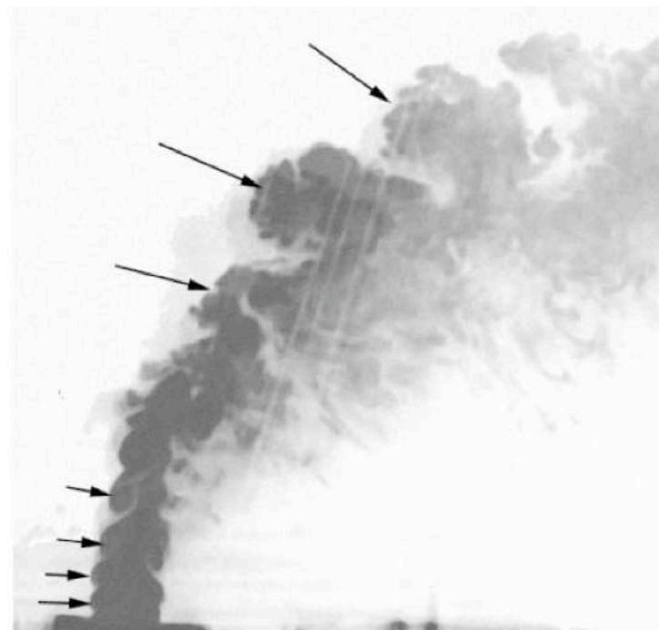
FIG. 2.17 - Visualisation des tourbillons de la couche cisaillée par fluorescence induite par plan laser. D'après Rivero et al. (2001).
