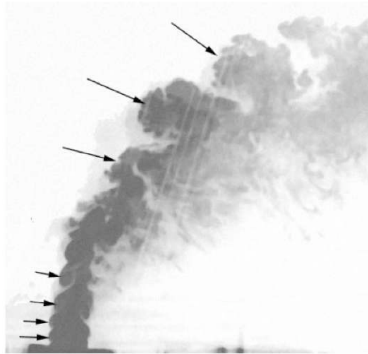
FIG. 2.17 - Visualisation des tourbillons de la couche cisailée par fluorescence induite par plan laser. D'après Rivero et al. (2001) .
