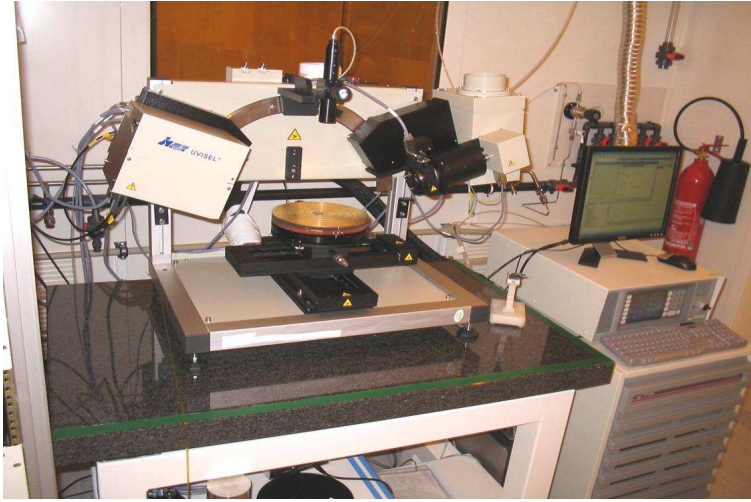
Fig. 2.6: Ellipsomètre Jobin-Yvon UVISEL associé au porte-échantillon chauffant.
