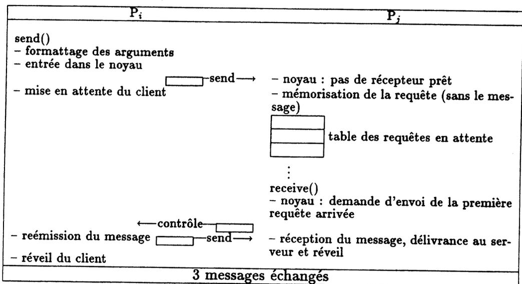
Figure 7.7: Exemple de déroulement de la primitive *send*
