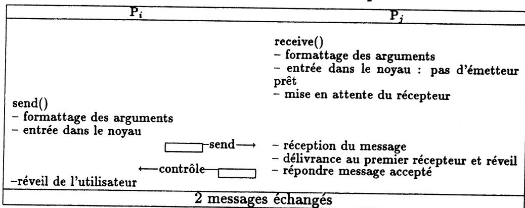
Figure 7.8: Autre exemple de déroulement de la primitive *send*
