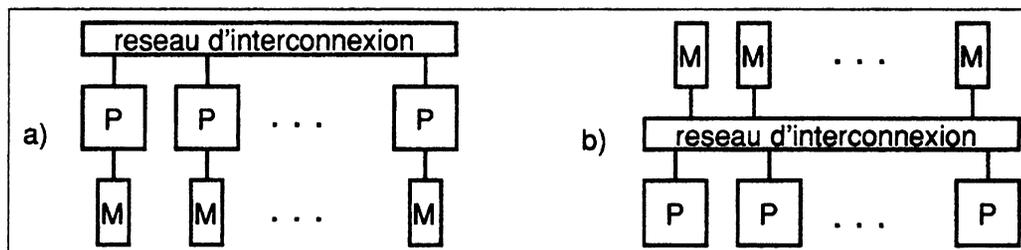
Figure 1.1: Schémas d'interconnexion des réseaux de processeurs
