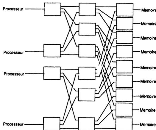
Figure 3.4: Réseau Banyan, appliqué à la connexion processeurs-mémoires
