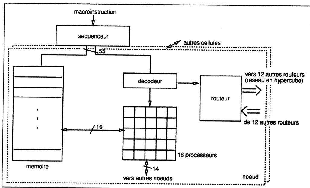
Figure 3.1: Un nœud de la Connection Machine
