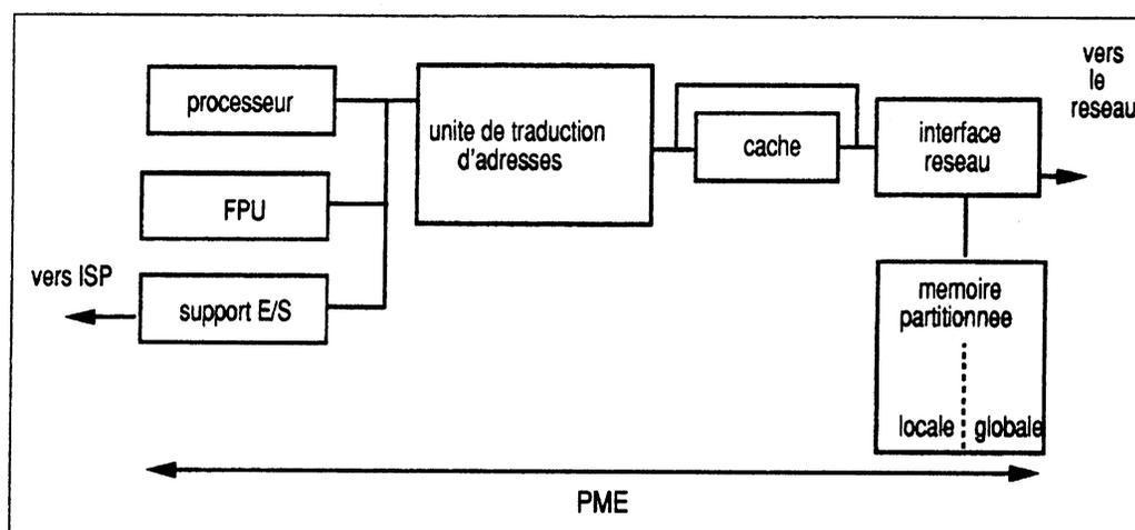
Figure 3.3: Un nœud de la machine RP3
