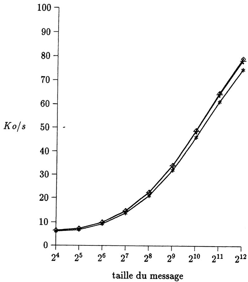
Figure 8.4: ralentissement de la communication par un processus de charge, 75, 85 et 95% de charge
