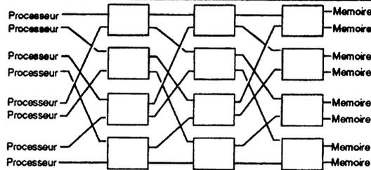
Figure 3.5: Réseau Omega appliqué à la connexion processeurs-mémoires
