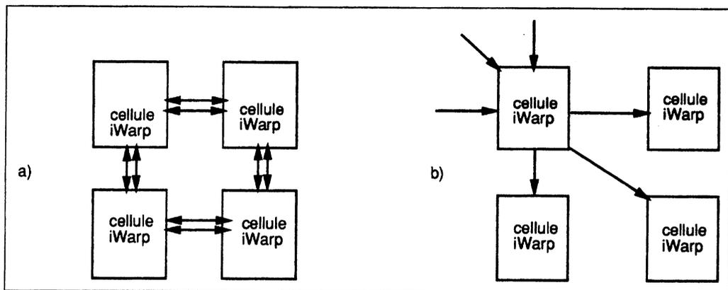
Figure 3.6: Différents réseaux pour la machine iWarp
