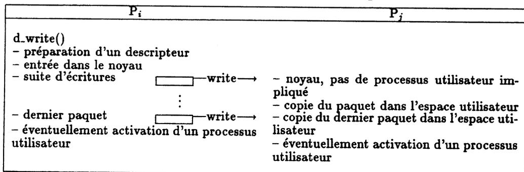
Figure 7.4: Exemple de déroulement de la primitive *write*
