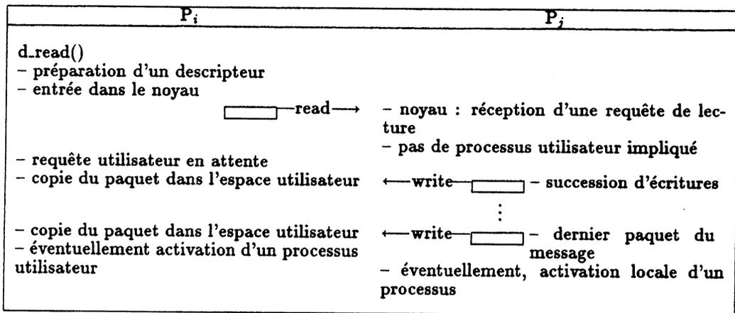
Figure 7.3: Exemple de déroulement de la primitive *read*
