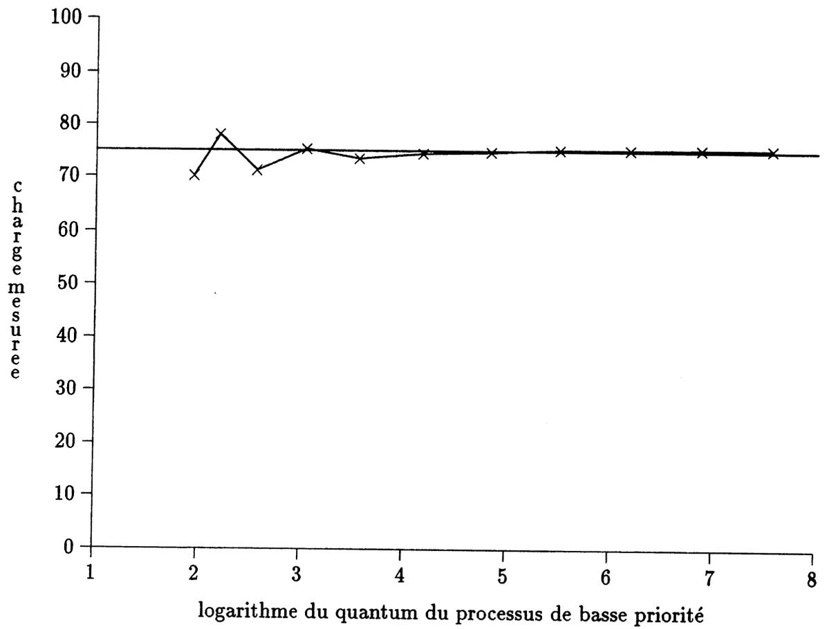
Figure 8.8: effet de la charge imposée pour différentes valeurs du quantum du processus de basse priorité mesuré,  $q = 1024\mu s$ ,  $l = 75\%$
