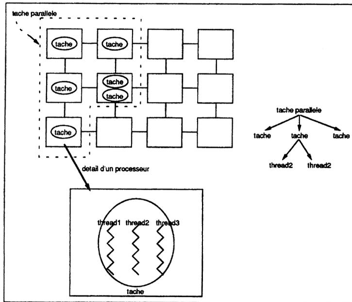
Figure 6.2: Ptâches, tâches et threads dans Parx
