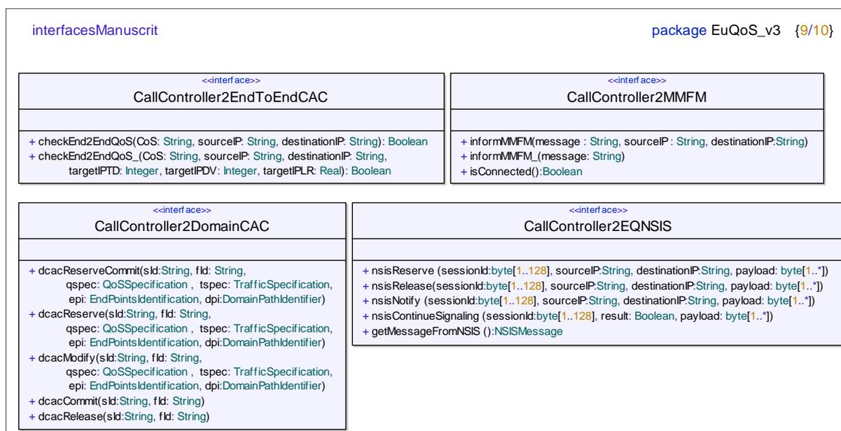
Figure 57 : Interface entre CallController et les modules adjacents
