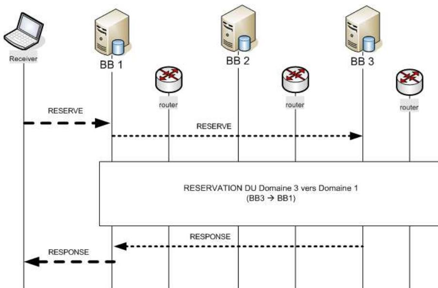
Figure 17 : Réserve initiée par le récepteur
