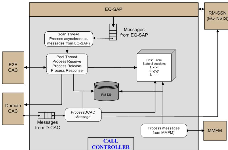
Figure 71 : Les flux de données dans le CallController
