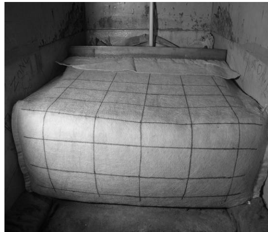
(d) Draw grids for monitoring displacement.
