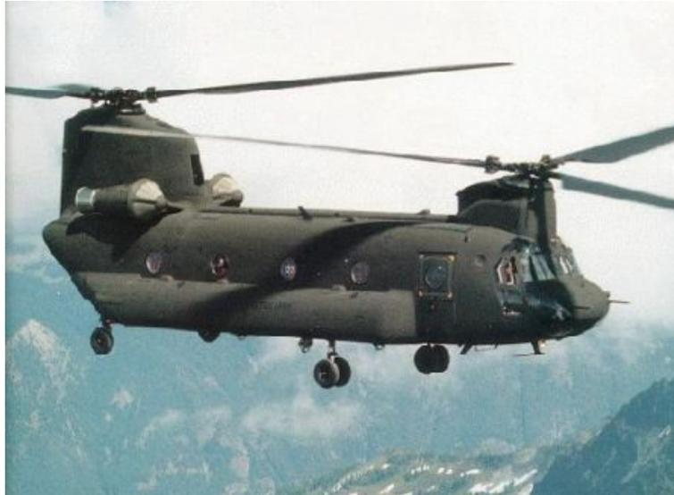
Fig. 2.7: Hélicoptère bi-rotor en tandem
