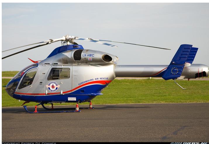
Fig. 2.6: Hélicoptère de type NOTAR
