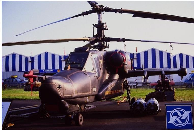
Fig. 2.8: Hélicoptère bi-rotor coaxial
