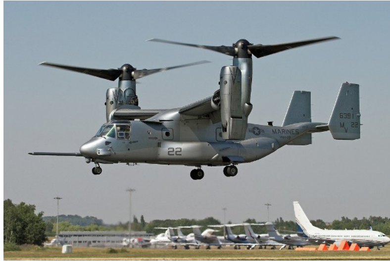
Fig. 2.11: Le convertible V22 Osprey
