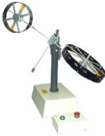
Fig. 1.10: Hélicoptère de laboratoire à deux rotors
