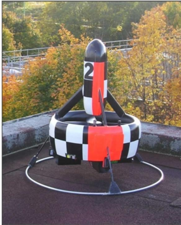
Fig. 2.28: Minidrone VTOL à hélice carénée
