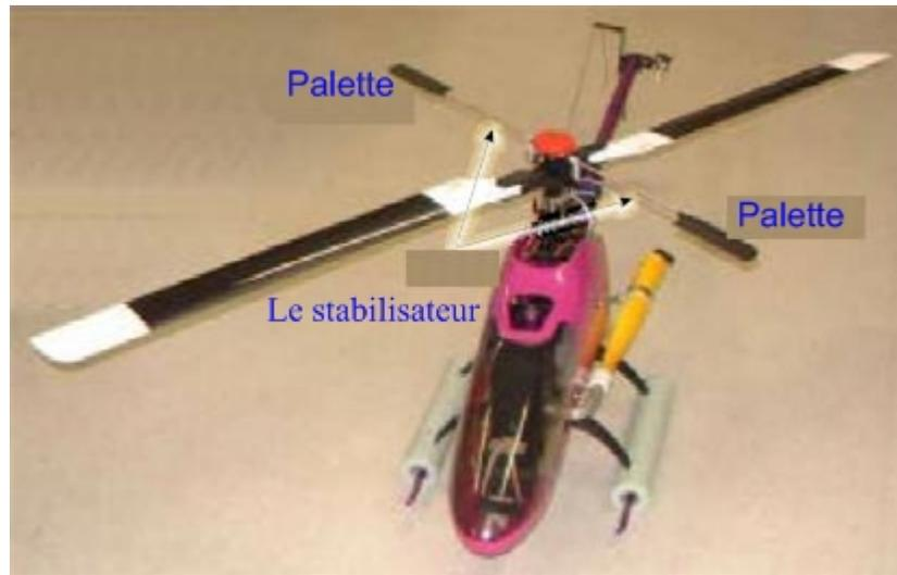
Fig. 2.20: *Le stabilisateur à inertie*
