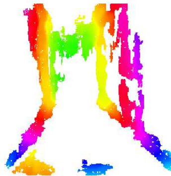
FIG. 3.8 – Un cas difficile pour la stéréo-corrélation : image de disparité (fausse couleur). Deux zones appariées sur le sol : la première est en bleu (appariements corrects), l'autre est en orange (appariements erronés). En fait la couleur orange correspond à la disparité au fond de l'image (les points les plus lointains)
