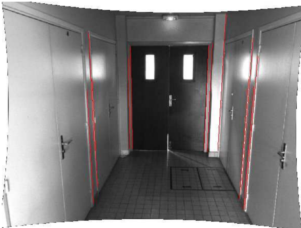
FIG. 4.14 – Les segments lignes 2D dans l'image.
