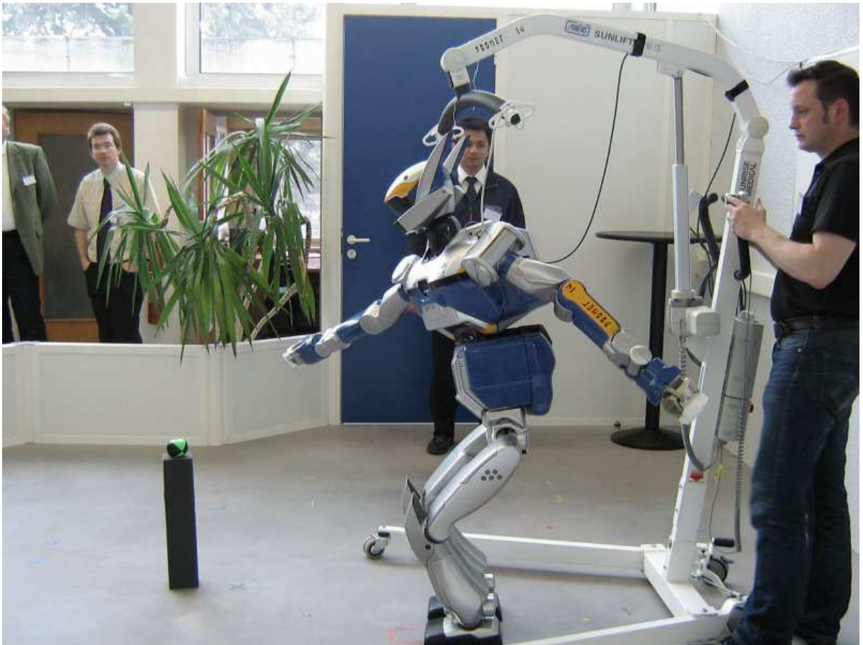
FIG. 2.6 – Le robot humanoïde HRP2 essaie d’attraper une balle posée sur un support.
