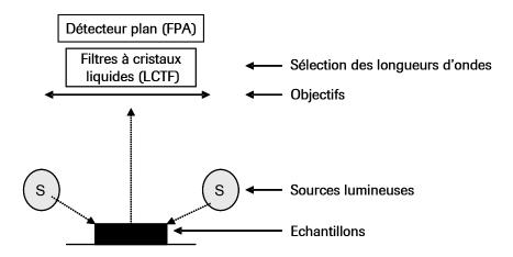
Figure 2. Schématisation du spectromètre utilisé.
