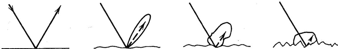
Figure II-4 : Schéma extrait de [57] montrant la transition du cas spéculaire (gauche) au cas Lambertien (droite) lorsque la rugosité de surface augmente.
