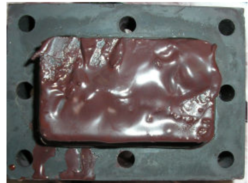
FIG. 3.58: Surface de la cathode à l'issue d'une manipulation.
