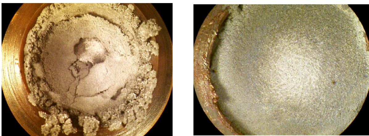
FIG. 3.62: Surface du dépôt obtenu sur du carbone vitreux (à gauche) et du platine (à droite).
