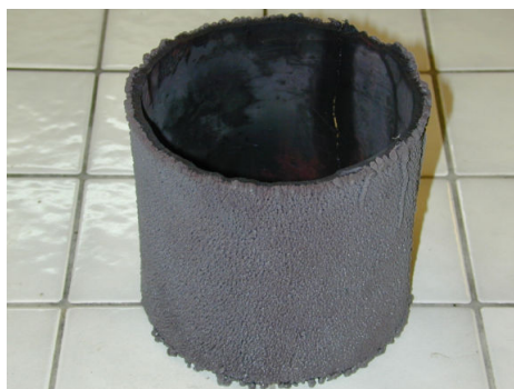
FIG. 3.69: Dépôt de fer obtenu sur cylindre tournant après 5 jours de manipulations. m = 1,560\text{kg} . ( j = 0,1\text{A} \cdot \text{cm}^{-2} , \omega = 80\text{tr/min} , rendement faradique \simeq 0,8 ).
