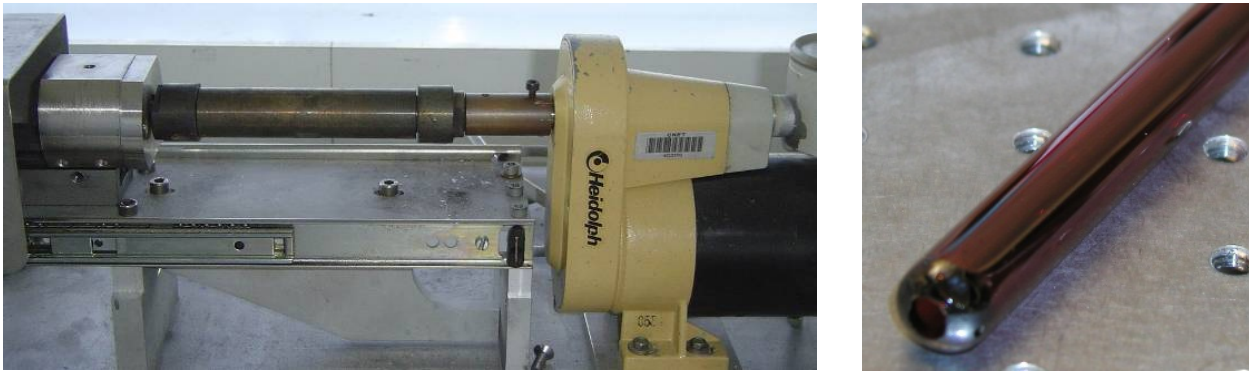
Figure 2.5.4 : À gauche, dispositif de "rotational casting" et à droite, tube de verre \text{Ge}_{22}\text{Ga}_3\text{Sb}_{10}\text{S}_{65} .
