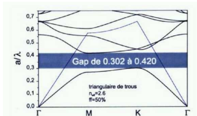
Figure 23 : structure de bandes d'un cristal photonique 2D triangulaire (paramètre a , facteur de remplissage f=50\% , indice du matériau 3.2) d'épaisseur finie ( h=0.44a ). Source GES, Montpellier, France
