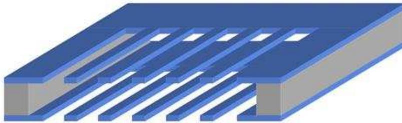
Figure 34 : Représentation schématique d'une cavité Fabry-Pérot à miroirs à CP 1D
