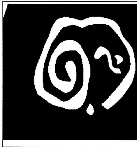
*Figure A.1.3 : Image de test pour l'opération d'étiquetage. La forte concavité de la figure exige un nombre de balayages importants pour les algorithmes locaux.*
