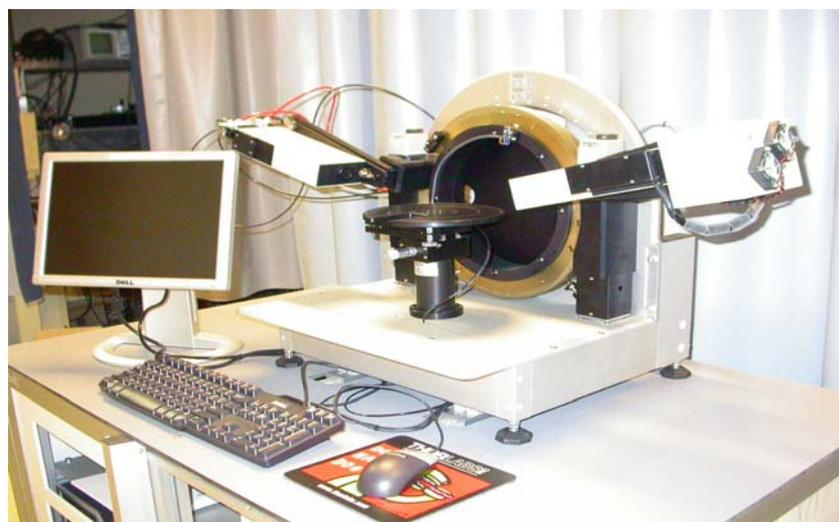
Figure II-13 : Ellipsomètre à polariseur tournant (modèle SOPRA GES5)
