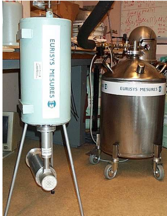
FIG. 3.12: Photographie de l'ensemble cryostat+détecteur.
