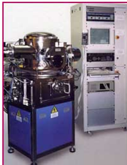
FIG. II.18 – Photographie du bâti de métallisation par évaporation
