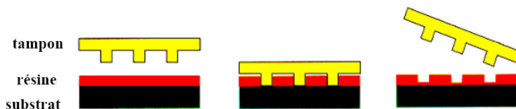
FIG. I.30 – Etapes de transfert du masque par nanoimprint
