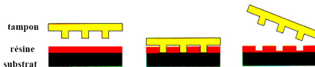
FIG. I.30 – Etapes de transfert du masque par nanoimprint
