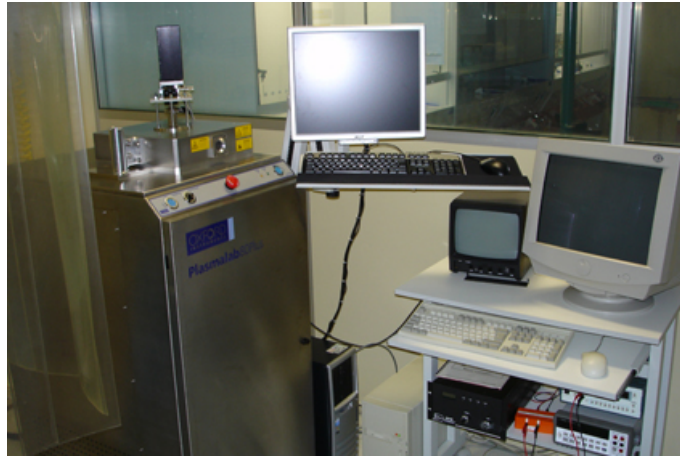
FIG. II.12 – Photographie du bâti de plasma RIE
