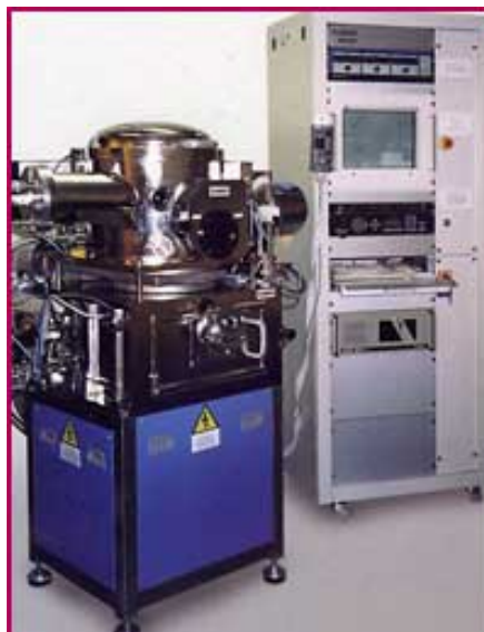
FIG. II.18 – Photographie du bâti de métallisation par évaporation
