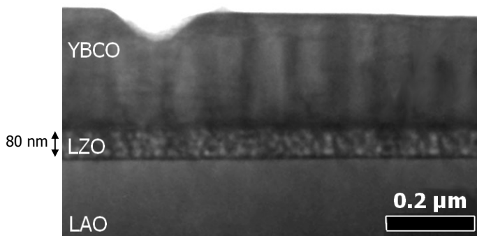
Figure 2.25 Image TEM à faible grossissement de l'hétérostructure LAO/LZO obtenue dans des conditions standard de synthèse - axe de zone [100] de LAO
