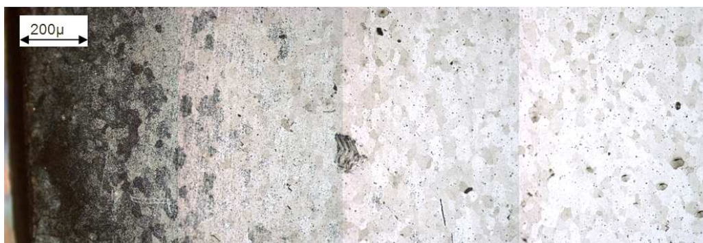
Figure 3.16 Image optique d'une couche d'YBCO : on cerne distinctement la microstructure granulaire du substrat de NiW
