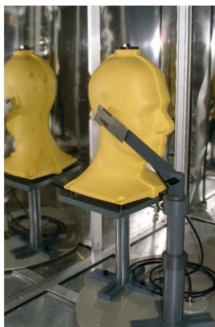
Fig. 68 : Photo de la mesure d'un système multi-antennaire en présence d'une tête (fantôme) dans la chambre réverbérante Bluetest
