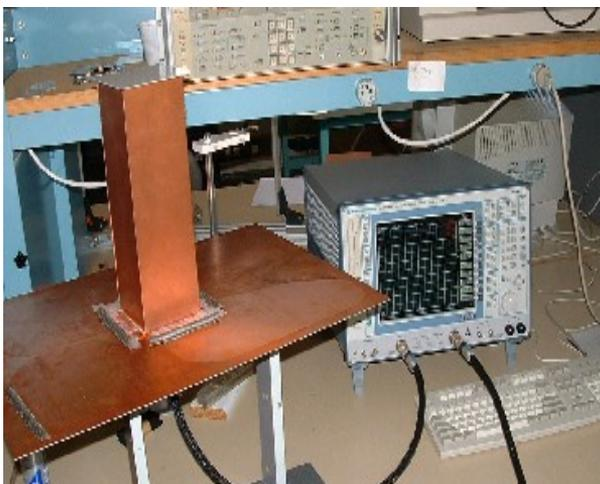
Mesure de l'antenne dans la *Wheeler Cap*
