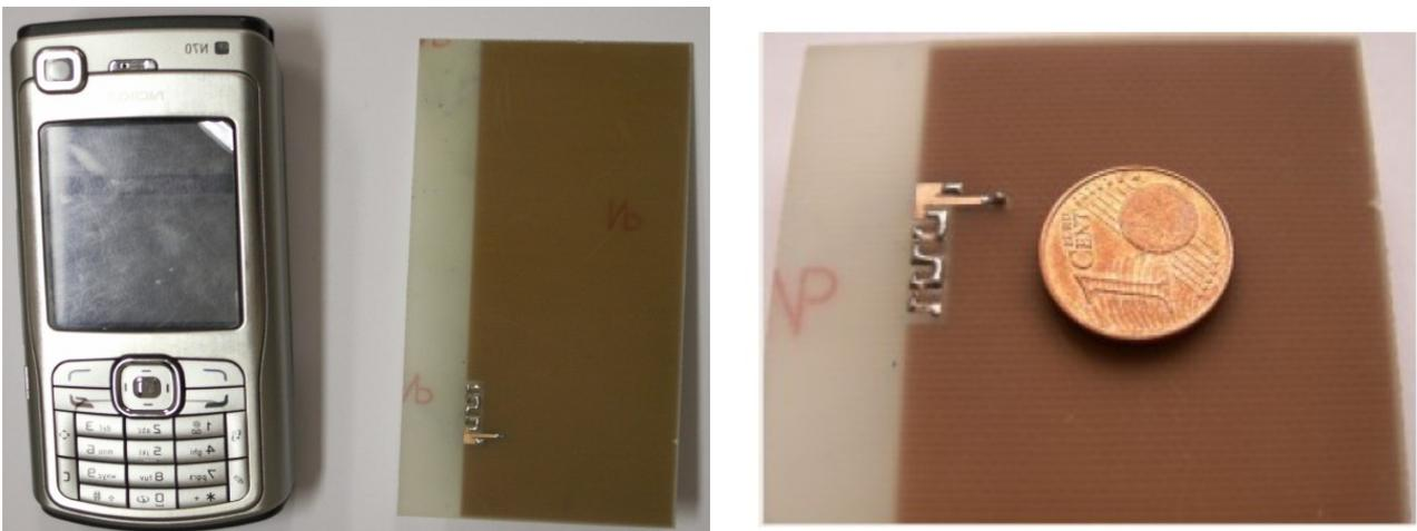
Fig. 162 : Antenne *IFA* spiralée réalisée dans une encoche d'un PCB (dimensions 13,2 x 1,8mm<sup>2</sup>)
