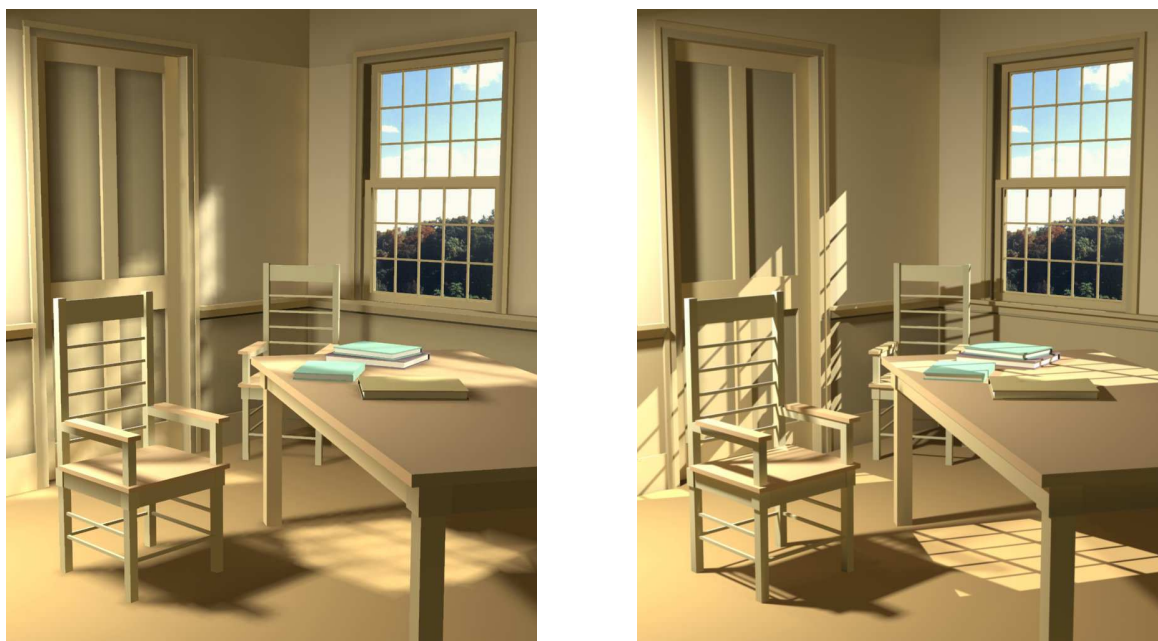
FIG. 1.8 – Ces deux images montrent la différence entre une scène rendue sans maillage de discontinuité (à gauche) et une scène rendue avec maillage de discontinuités (à droite). Un plus grand flou apparaît sur l'image de gauche. Ces images sont extraites de [77].
