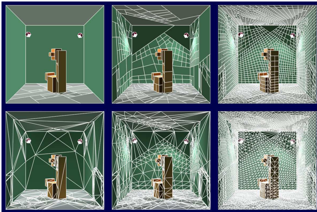
FIG. 1.5 – Divers maillages d'une scène, tirés de [77]. Les éléments des maillages représentés sur la ligne supérieure sont des quadrilatères alors que ceux de la ligne inférieure sont des triangles.
