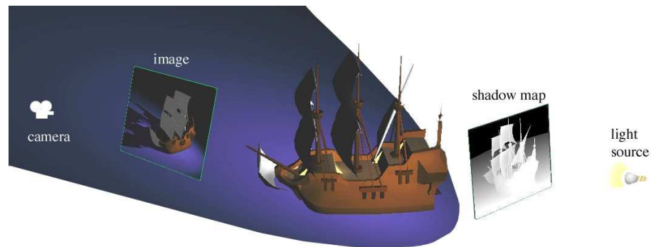
FIG. 3.13 – La vue depuis le point lumineux est calculée et stockée dans la carte des ombres. La scène est ensuite rendue depuis le point de vue en prenant en considération les informations contenues dans la carte des ombres. Image extraite de [32].
