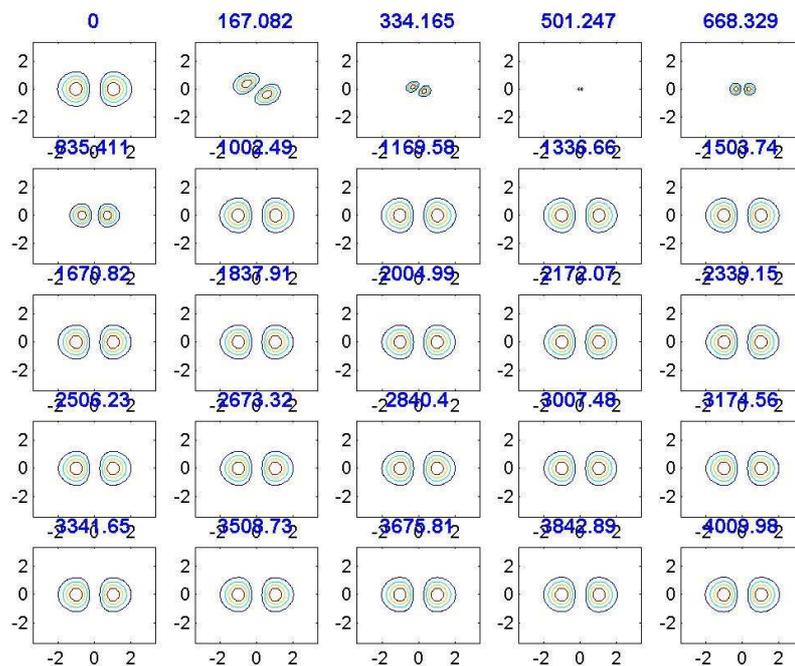
Figure 2.32. Profil d'intensité du mode 01 en fonction de  $x$  et  $y$  pour une cavité à 2D.
