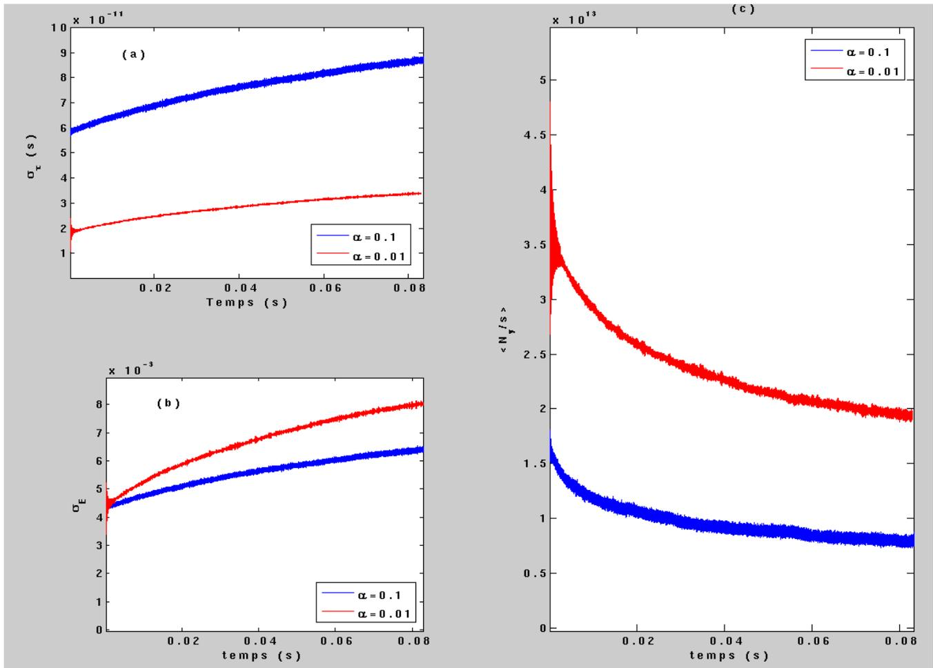
Figure 3.12. (a) largeur du paquet en fonction du temps. (b) la déviation de l'énergie en fonction du temps. (c) le flux de rayons X en fonction du temps sur un temps  $t=30$  ms. (en rouge) pour  $\alpha=0,01$  et (en bleu) pour  $\alpha=0,1$ .
