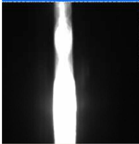
Figure 3.9. Profil du faisceau de la diode mesuré par une CCD.
