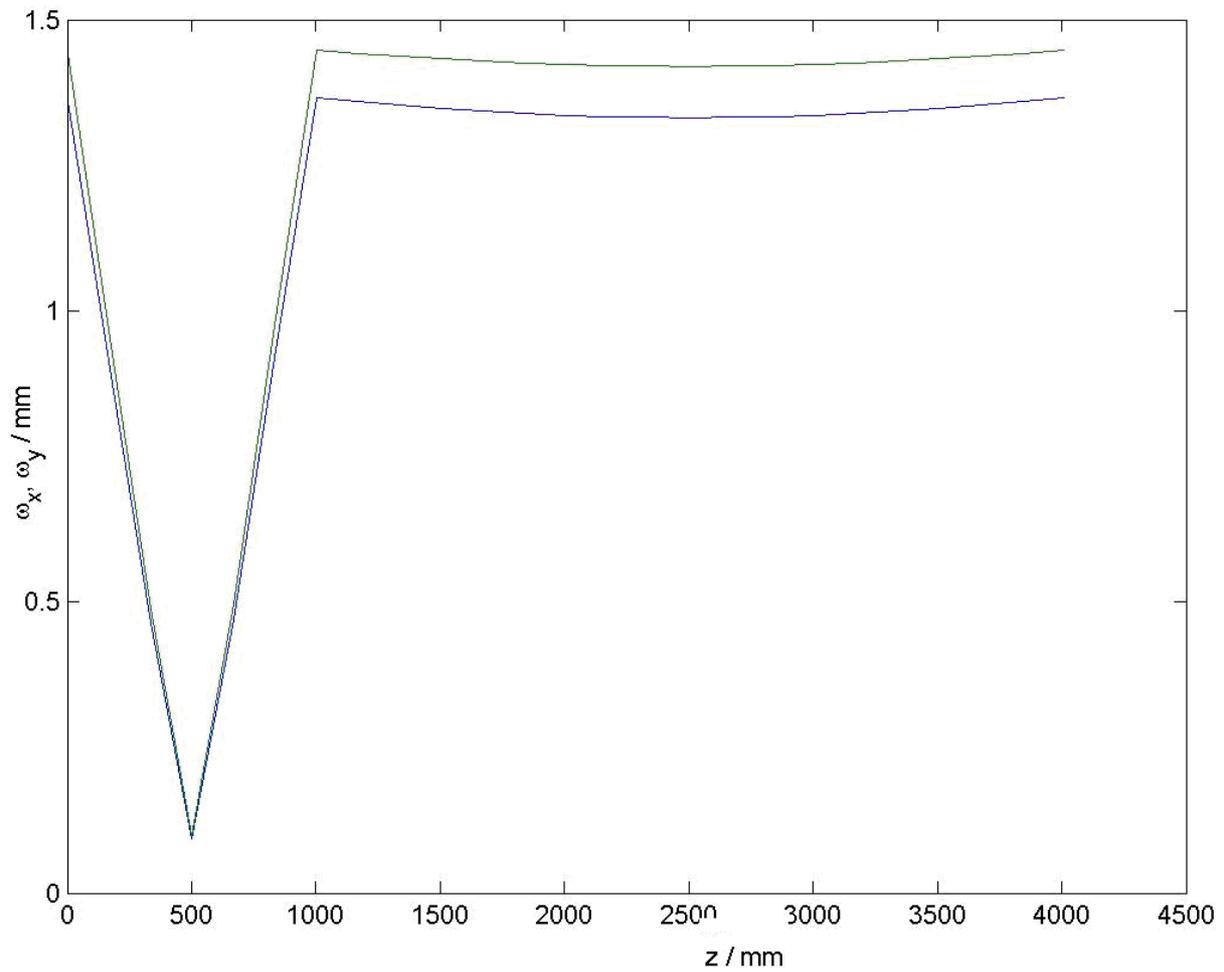
Figure 2.30. Waists du faisceau en fonction de  $z$  pour une cavité à 2D. Les 2 courbes correspondent aux deux directions orthogonales (une est dans le plan du chemin optique).
