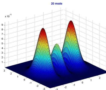
Figure 2.28.  $h = 50$  mm,  $z = 0$ , mode 20 pour une cavité plane.
