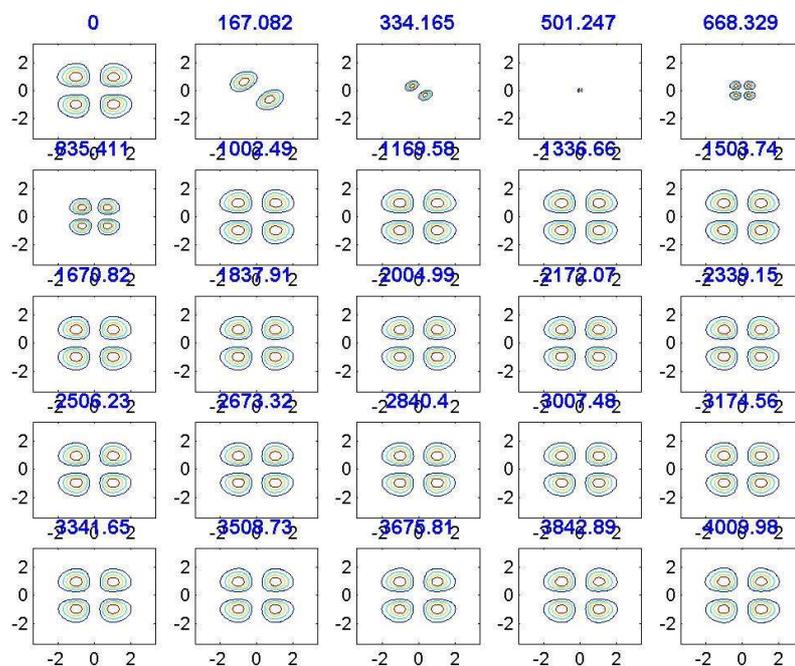
Figure 2.33. Profil d'intensité du mode 11 en fonction de  $x$  et  $y$  (en mm) pour une cavité à 2D.
