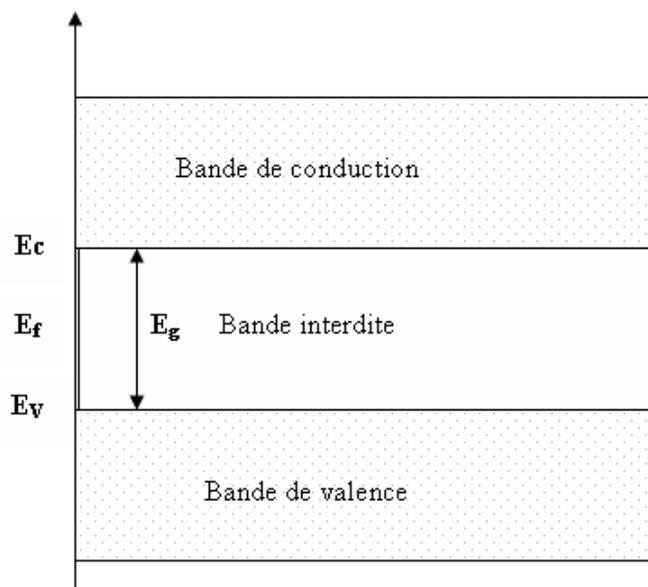
Figure 3.1. Bande d'énergies des semi-conducteurs à 0 K.
