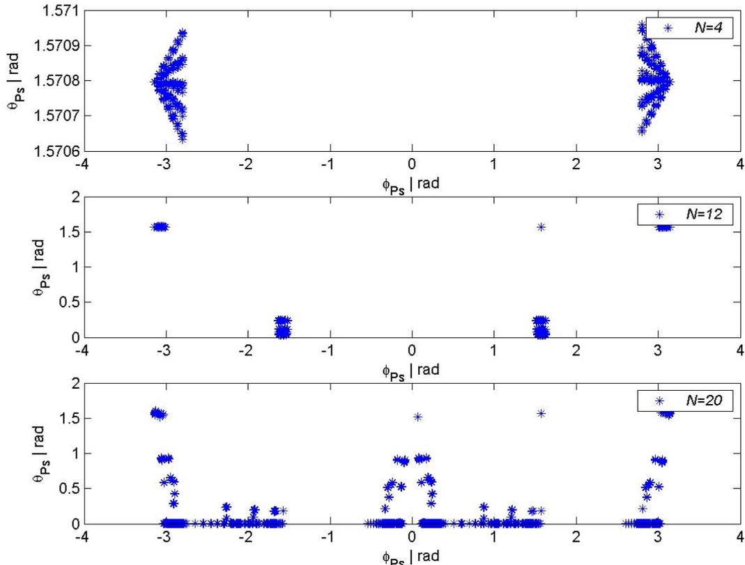
**Figure 2.4. Représentation des vecteurs propres sur la sphère de Poincaré pour une cavité en Bow-tie et pour plusieurs nombres  $N$  de multicouches de revêtement des miroirs.**
