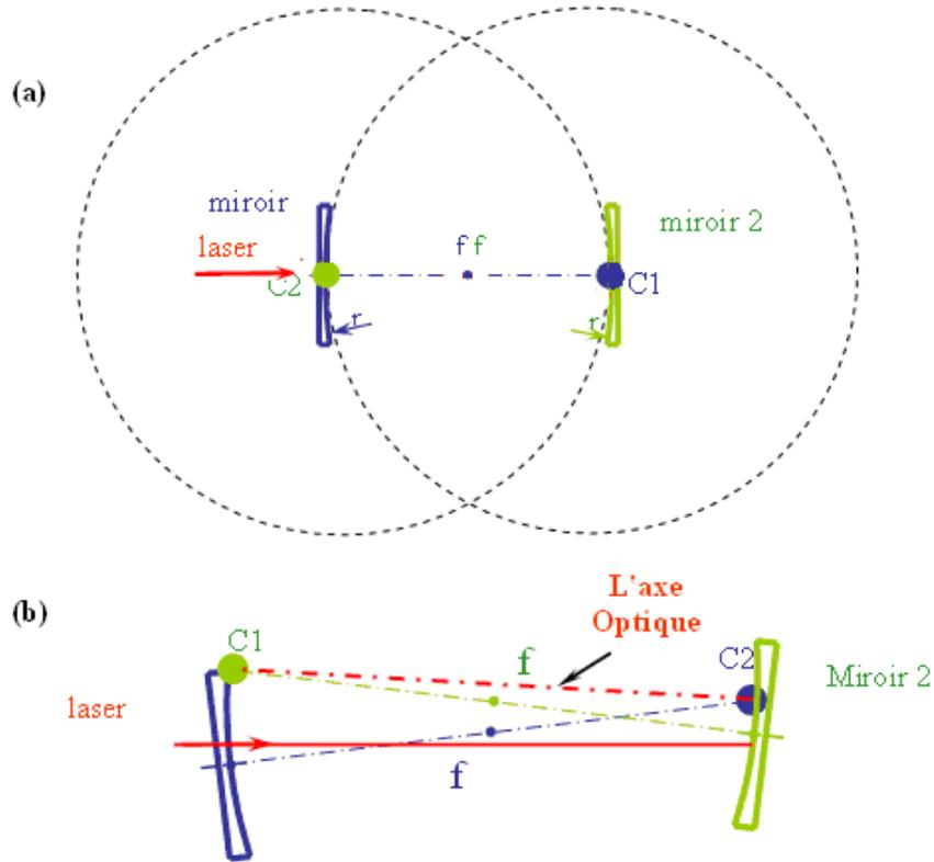
Figure 1.3. Schéma d'une cavité à géométrie confocale (a) alignée (b) désalignée. Le plan focal est situé à une distance  $R/2$  des miroirs.  $R$  est le rayon de courbure des miroirs.  $C1$  et  $C2$  sont les centres de courbure des miroirs 1 et 2 respectivement.
