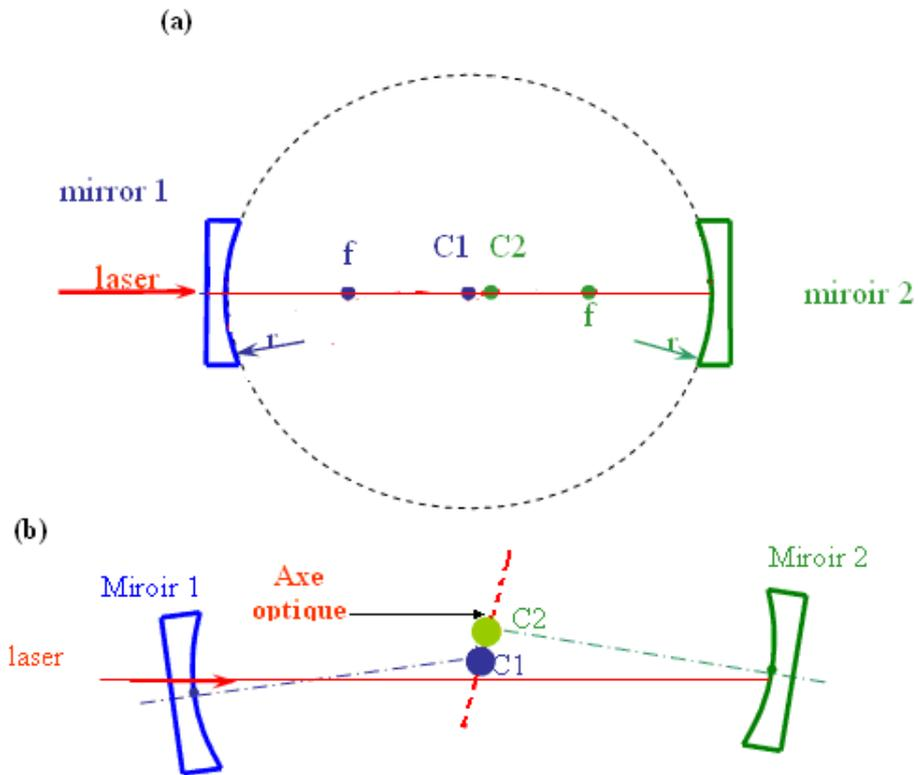
Figure 1.4. Cavité à géométrie concentrique (a) alignée (b) désalignée.
