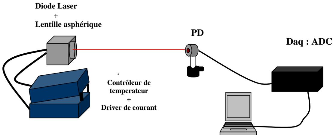
Figure 3.7. Dispositif expérimental pour le tracé de la caractéristique de la diode.
