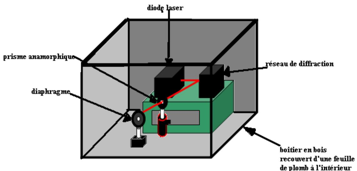
Figure 3.19. Système de la diode laser en configuration Littrow sous le boîtier d'isolation.
