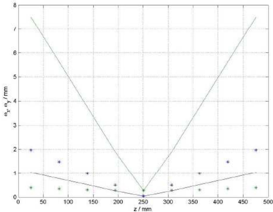
Figure 2.39. Rayon du faisceau laser entre les miroirs sphériques : les traits pleins sont les résultats de calculs en 3D, les étoiles correspondent à la formule paraxiale standard  $\omega(z) = \omega_0 \sqrt{1 + (z/z_R)^2}$  qui n'est pas valable en 3D.
