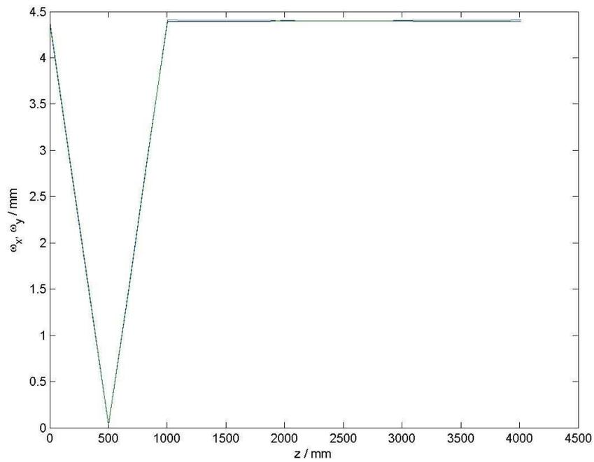
Figure 2.15.  $h = 50$  mm. Waist du faisceau en fonction de  $z$  pour une cavité non planaire. Les courbes sont les unes sur les autres.
