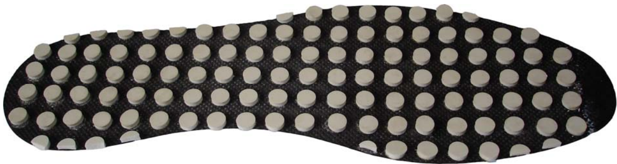
Figure 36 : Semelles munies de reliefs en caoutchouc et utilisées lors de cette étude.
