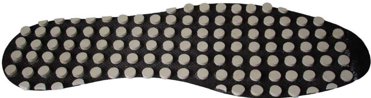
Figure 36 : Semelles munies de reliefs en caoutchouc et utilisées lors de cette étude.
