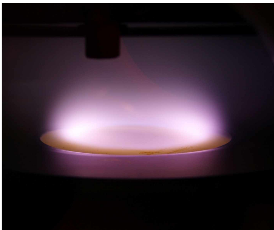
Figure II.8 : Dépôt d'une couche mince de composition molaire 30% \text{RuO}_2 -70% \text{CeO}_2
