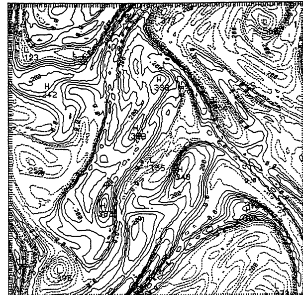
FIGURE 10.15 comparaison de lignes d'iso-tourbillons pour N = 128 et N = 256
