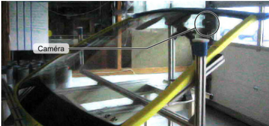
FIG. 2.8: La caméra est placée en haut, proche du rétroviseur central.
