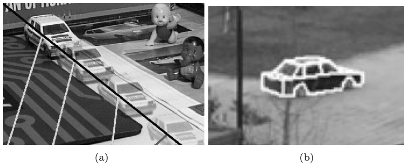
FIG. 6.2: A gauche : Avidan et Shashua [AS99] montrent que sous l'hypothèse d'un mouvement linéaire, le déplacement d'une cible peut être reconstruit avec un système monoculaire. A droite : Lou et al. [LTH + 05] proposent un modèle en « fil de fer » 3-D spécifiquement adapté aux véhicules à 4 roues.
