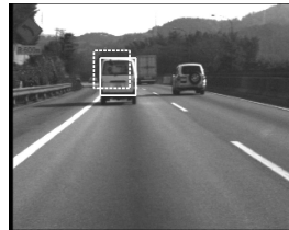
FIG. 6.7: (à droite) L'approche Support Vector Tracking [Avi04] part de la position précédente (trait pointillé) pour converger vers une texture optimisant le critère SVM (trait plein). La mise à jour itérative du vecteur de déplacement est inspirée des méthodes de calcul de flux optique.
