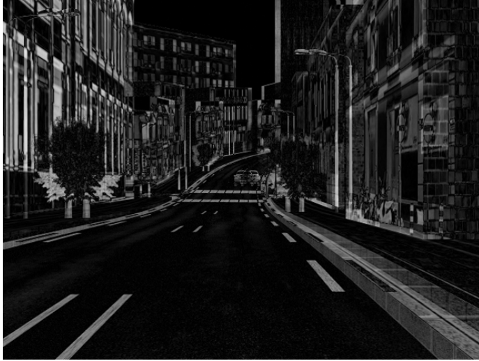
FIG. 4.4: Le critère AD (différence absolue des intensités) est calculé entre chaque pixel de l'image gauche (voir la figure 4.2) et son homologue dans l'image droite.
