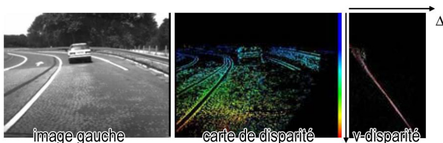
FIG. 5.3: L'approche de Labayrade et al. [LAT02] consiste à créer une pseudo vue de coté de la carte de disparité, appelée v-disparité ( v pour l'axe v de l'image) dans laquelle se dessine le profil de la route et des obstacles.
