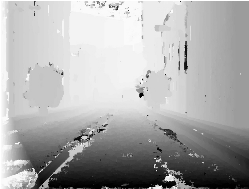
FIG. 4.3: La carte de disparité issue de la paire d'image de la figure 4.2. Les disparités basses (environ -100), qui correspondent à des points proches, sont représentées en sombre. Au contraire, les disparités hautes (proches de 0), affichées en clair, représentent des points éloignés.
