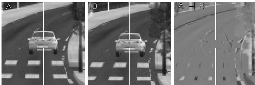
FIG. 4.18: La faible différence d'apparence entre les régions support A et B du point \mathbf{m}_1 entraîne un minimum de 0.01 de la fonction de corrélation C_{SAD} sur une fenêtre carrée de 11 \times 11 pixels.
