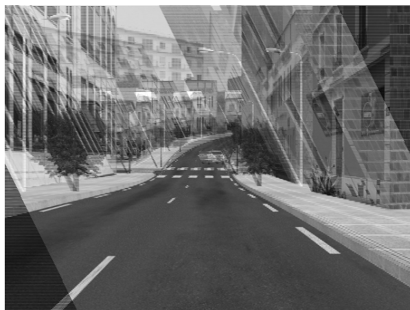
FIG. 3.11: Avec une rectification par le plan de la route, la route apparaît à l'identique dans les images gauche et droite, ici entrelacées.
