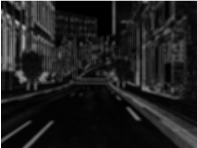
FIG. 4.5: Chaque pixel de cette image affiche la moyenne du score de corrélation (ici AD) sur une fenêtre l'entourant de 7x7 pixels.
