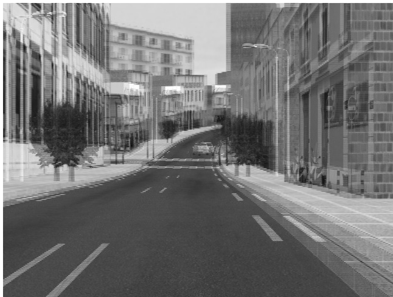
FIG. 3.2: Avec une rectification fronto-parallèle, la disparité dans les images gauche et droite (ici entrelacées) est strictement horizontale.
