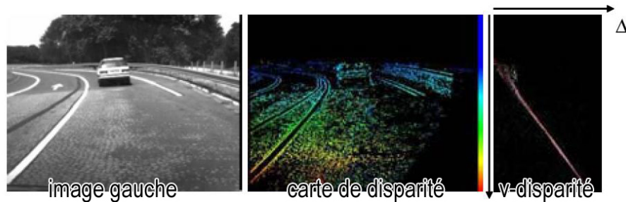
FIG. 5.3: L'approche de Labayrade et al. [LAT02] consiste à créer une pseudo vue de coté de la carte de disparité, appelée v-disparité ( v pour l'axe v de l'image) dans laquelle se dessine le profil de la route et des obstacles.
