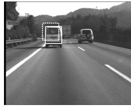
FIG. 6.7: (à droite) L'approche Support Vector Tracking [Avi04] part de la position précédente (trait pointillé) pour converger vers une texture optimisant le critère SVM (trait plein). La mise à jour itérative du vecteur de déplacement est inspirée des méthodes de calcul de flux optique.
