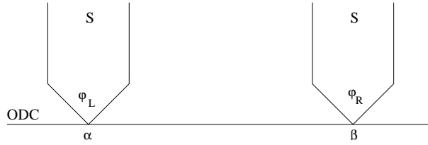
FIG. 4.4 – Structure de deux pointes supraconductrices en contact avec une onde de densité de charge.
