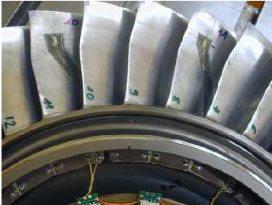
FIG. 5.6 Position des jauges sur les pales
