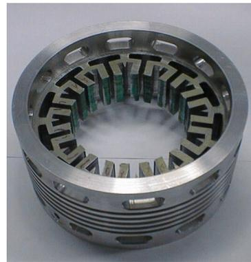
FIGURE 1.44 – Photo du stator sans bobinage
