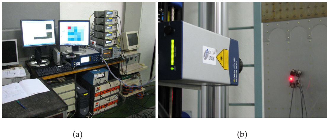
Figure 20 – (a) Instrumentation TR-NEWS installée sur le site du centre aéronautique VZLU à Prague. (b) Vibromètre laser Polytec OFV-505 mesurant la vitesse à la surface de l'échantillon
