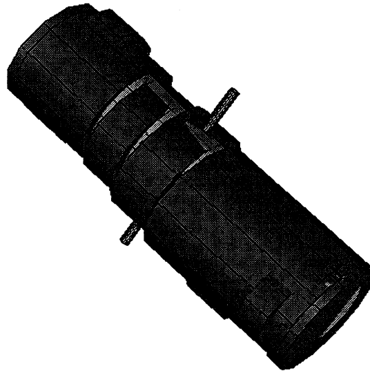
FIG. 4.8 - : Contre exemple à l'heuristique de sur-reconstruction. L'épingle en travers du cylindre a échappé à la reconstruction.
