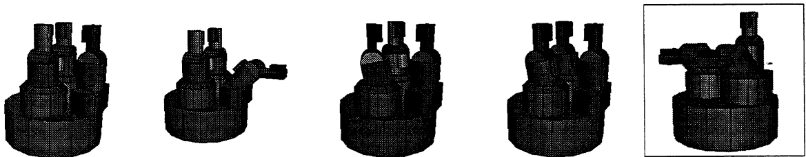
FIG. 5.17 - : Le modèle de OTD avec ces principales originalités . Huit degrés de liberté dont deux pour le pouce. Image (2) : saisie bi-digitale. Image (3) : orientation sphérique. Image (4) : orientation cylindrique. Image (5) : orientation digito-palmaire.
