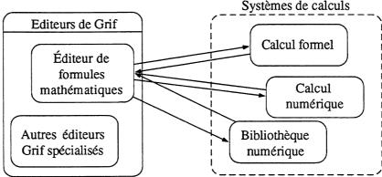
Fig. 2.1: Architecture de l'interface de calcul scientifique
