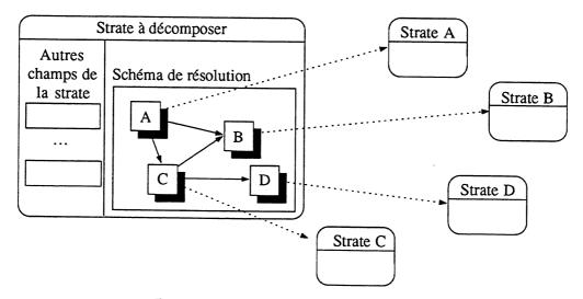
Fig. 5.2 : Exemple de décomposition de strate
