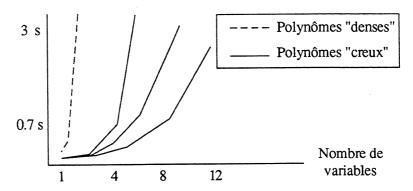
Fig. 2.2: Temps cpu moyens de détermination des solutions dans Z/3Z
