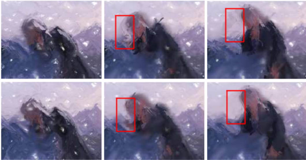
FIGURE 7.11 – Influence du délai d de ré-initialisation après déclenchement d'une correction. La première ligne à un délai de zéro images, nous notons les traces restant après une corrections. La deuxième ligne à un délai de trois images, les traces restante après une corrections sont supprimées dans les images suivantes.
