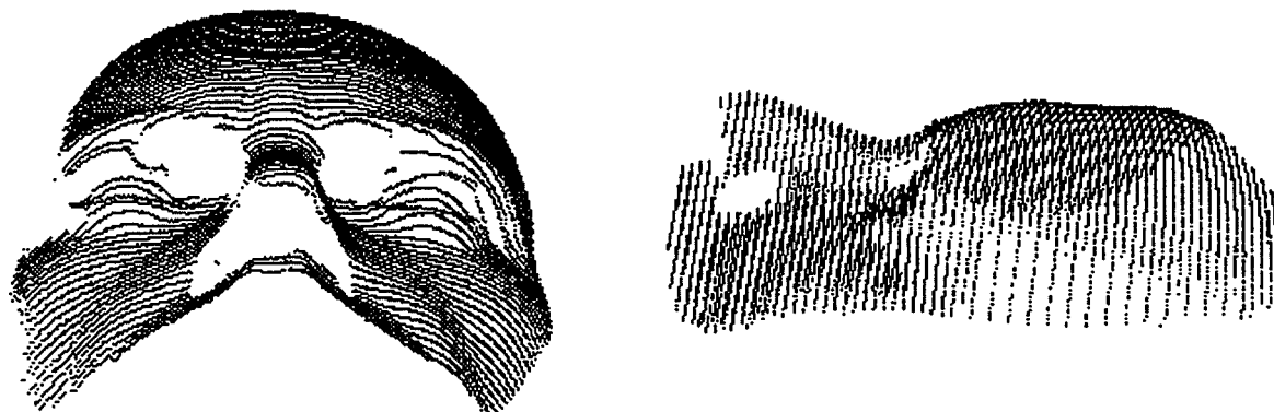
FIG. 4.13 - Vues de face et de profil de la surface S' obtenue par le capteur laser/caméra.
