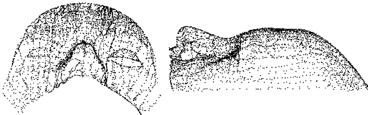
FIG. 4.12 - Vues de face et de profil du modèle de la surface S obtenue par palpeur 3D.
