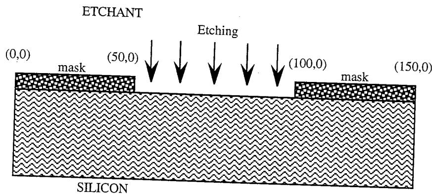
*Fig. 3.5.1.3. Coupe transversale d'une microstructure avant la gravure*
