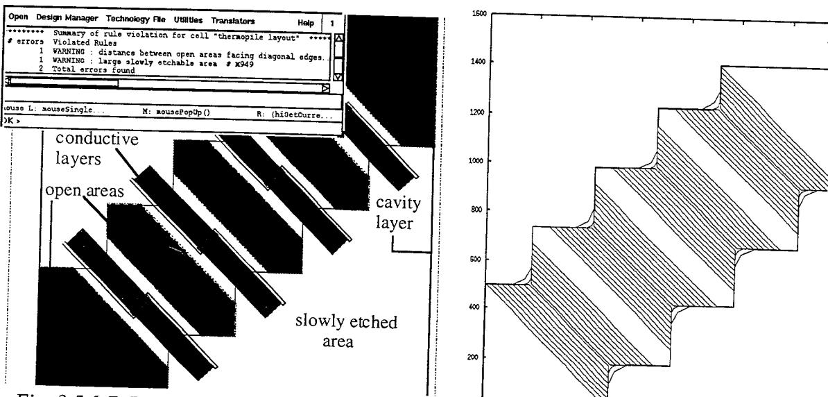
*Fig. 3.5.1.7. Prédiction d'un problème de post-process sur un layout d'un capteur infra-rouge (à base de thermopiles) correspondant à une gravure de 5 heures avec une solution EDP à 80 °C*
