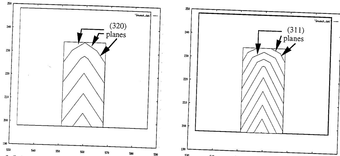
*Fig. 3.5.1.5. Résultats respectifs de simulations des gravures par KOH et EDP d'une micro-poutre*
