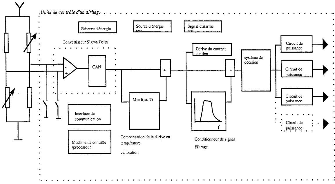
Fig. 1.2.1. Architecture d'un airbag de voiture
