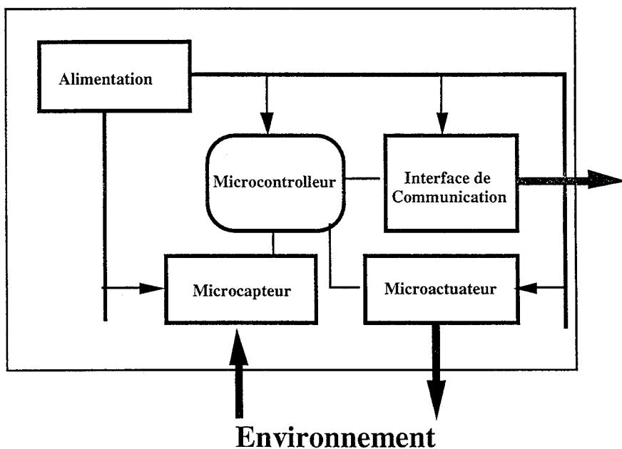
Fig. 1.1.1. Architecture générale d'un microsystème
