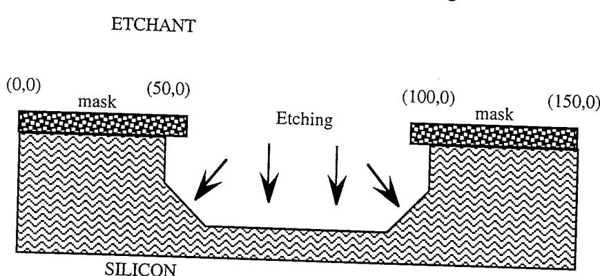
*Fig. 3.5.1.4. Exemple de structure obtenue après la gravure*
