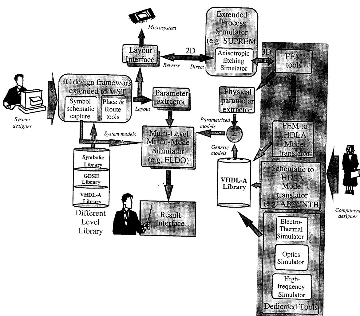
*Fig. 3.8.1. La structure globale de l'environnement de CAO des microsystèmes*
