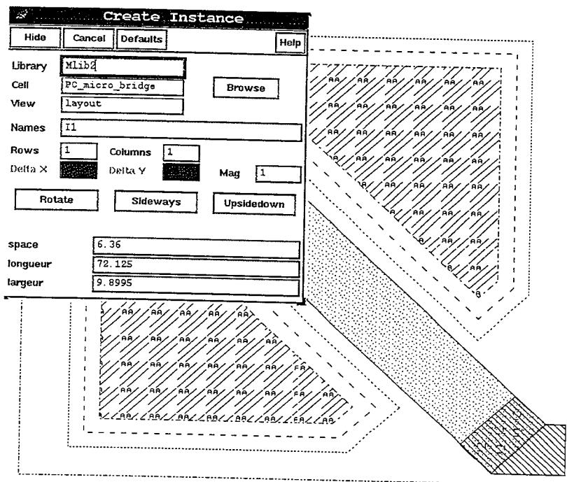
*Fig. 3.4.4.1.3. Instanciation d'une cellule paramétrisable de micro-pont*
