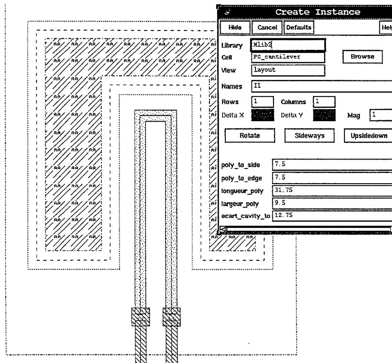
*Fig 3.4.4.1.1. Instanciation d'une cellule paramétrisable de micro-poutre*
