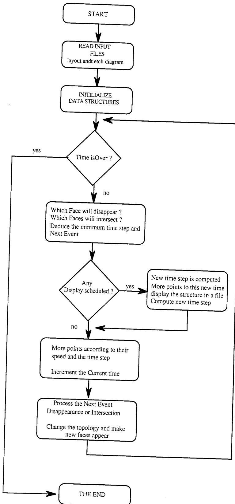
*Fig. 3.5.1.4. Les différentes étapes d'exécution du simulateur*
