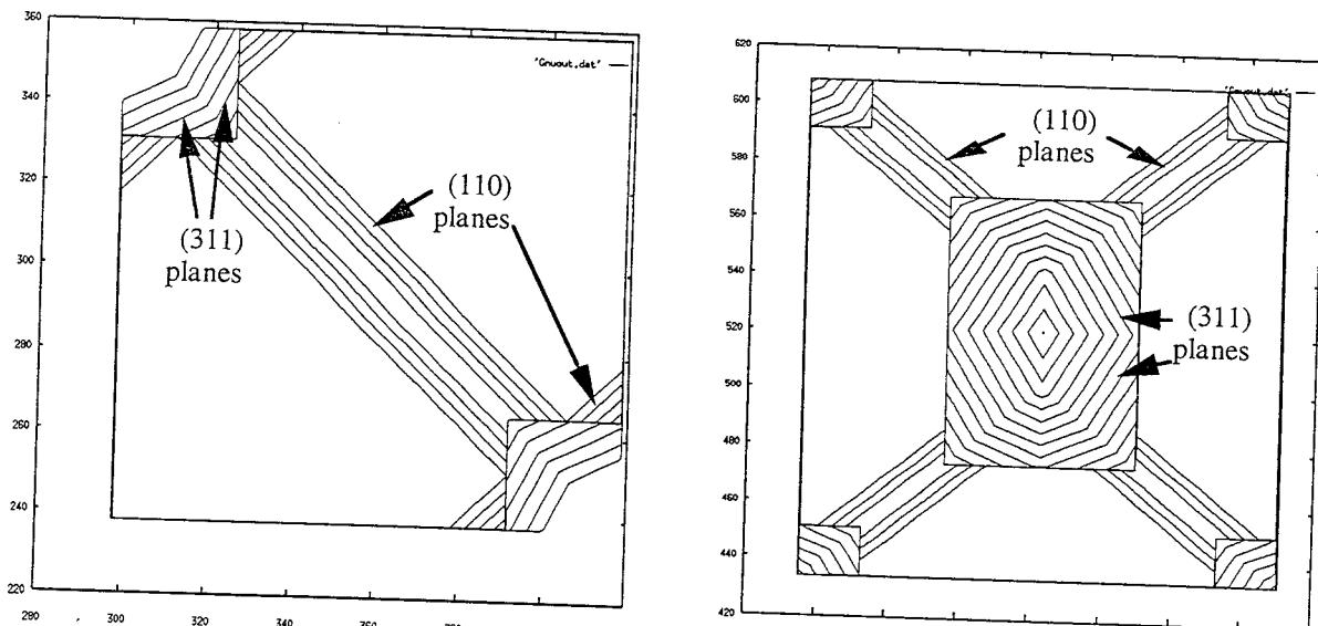
*Fig. 3.5.1.6. Simulation de la gravure par EDP d'un micro-pont et une micro-membrane (temps de gravure 120 min et 180 min respectivement)*
