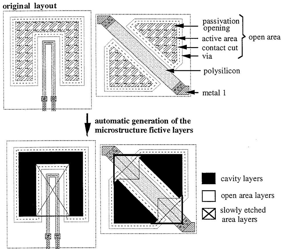
Fig. 3.4.3.1. La génération des couches fictives relatives aux microstructures
