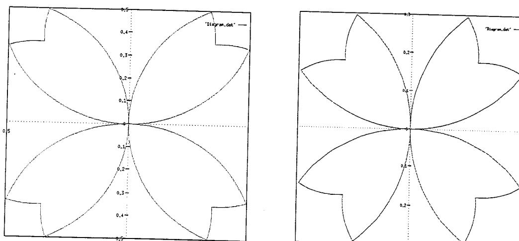
*Fig. 3.5.1.2. Les diagrammes de gravure du silicium relatifs au KOH (40%, 50 °C) et EDP (80 °C) respectivement*
