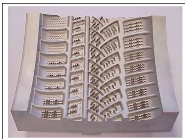
*Figure 1.2 – Emplacement des lamelles dans le moule.*
