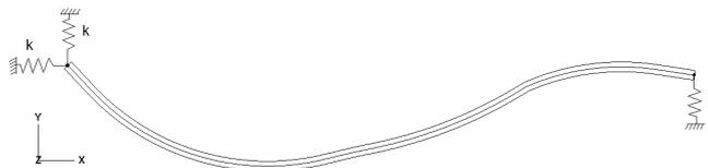
Figure 6.14 – Elimination du mouvement de corps rigide.
