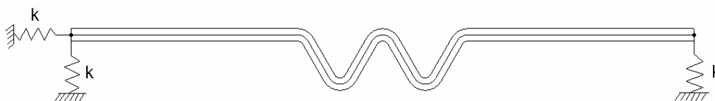
Figure 3.10 – Blocage du mouvement des corps rigide.
