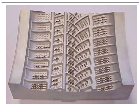
Figure 1.2 – Emplacement des lamelles dans le moule.
